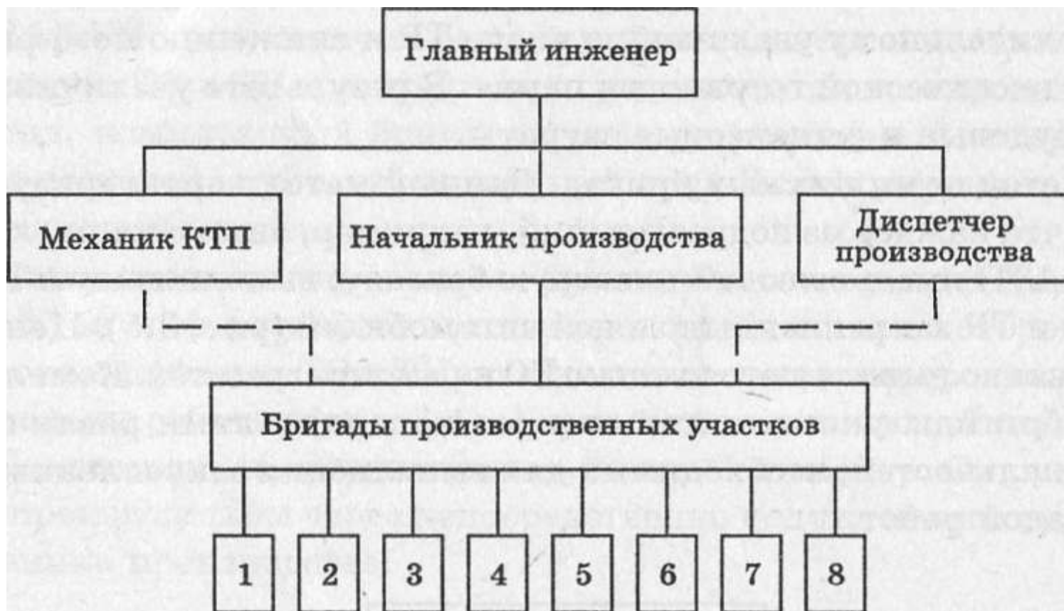
Схема организации производства ТО и ремонта автомобилей агрегатно-участковым методом
