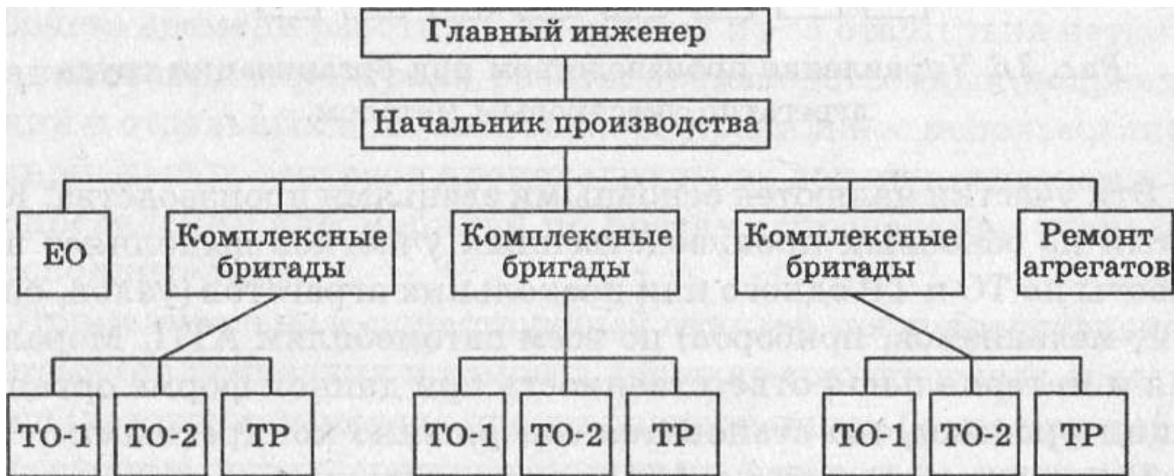
Схема организации производства ТО и ремонта автомобилей комплексными бригадами
