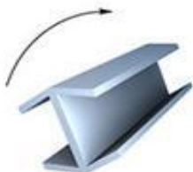
Сварка поочередно чотирьох швов балки (с перекантовкой)
