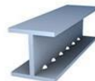
Сборка балки на прихватки
