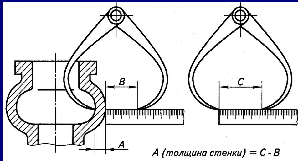
К косвенным методам измерения приходится прибегать зачастую в различных случаях, когда по каким-либо причинам нет возможности произвести прямые измерения прикладыванием инструмента к изделию.
