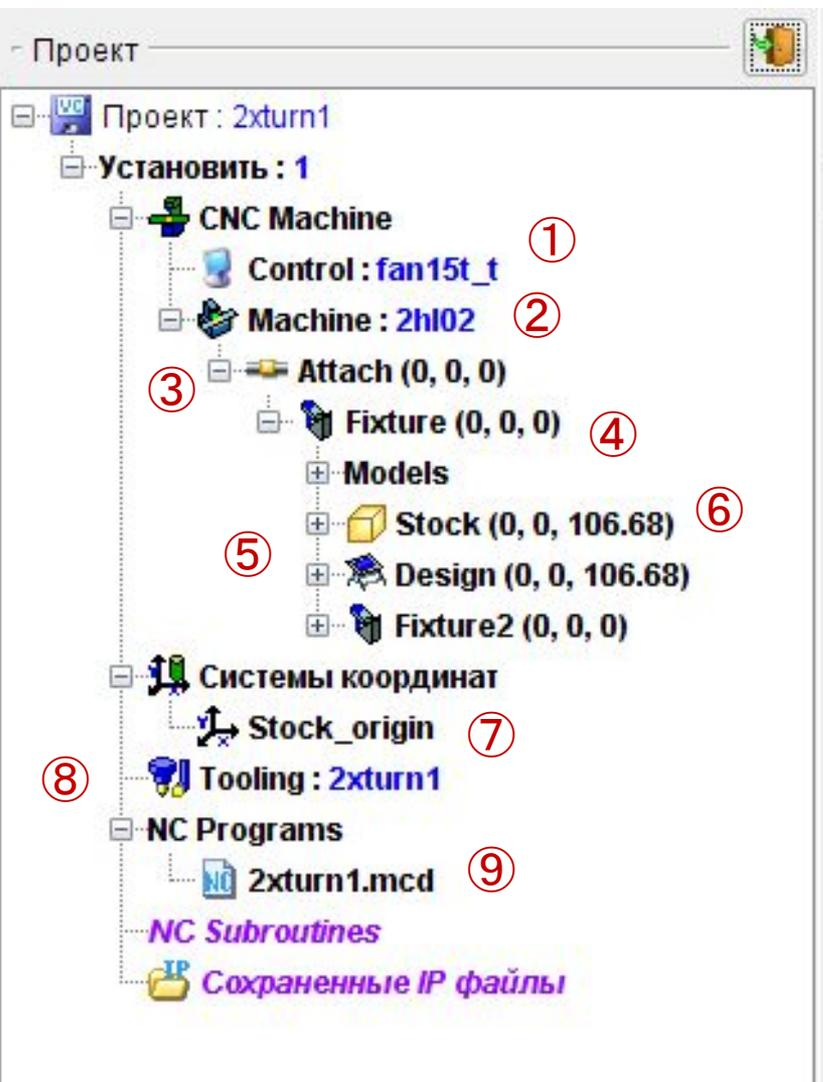
Включает эмулятор стойки ЧПУ (1), кинематическую схему (2) и модели узлов станка (3), модели приспособления (4), детали (5) и заготовки (6), систему координат (7), магазин инструмента (8) и УП (9).
