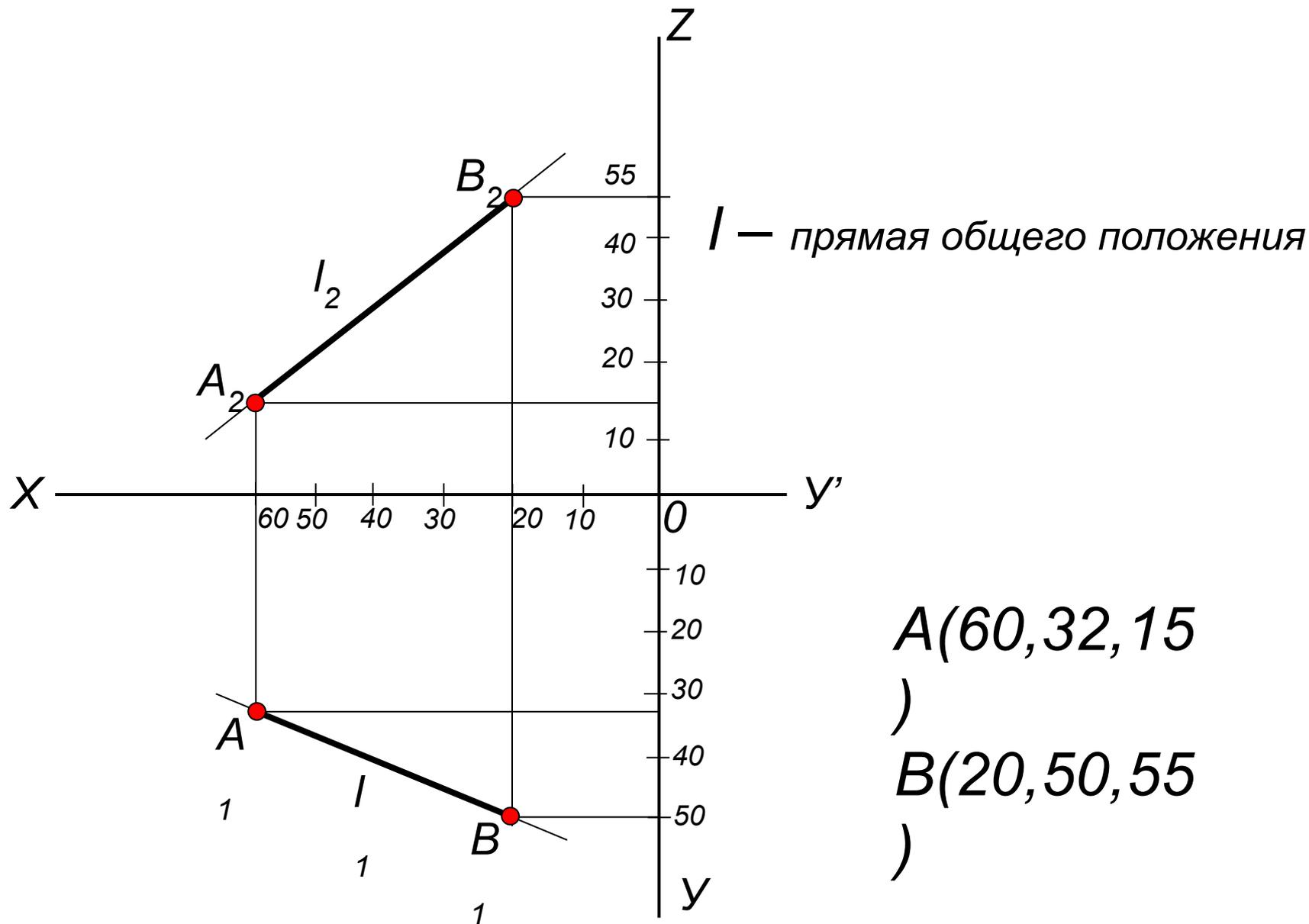
Задача 16б. Прочитать чертеж прямой. В случае задания прямой отрезком  $AB$ , определить координаты  $X, Y, Z$  точки  $A$  и точки  $B$ .
