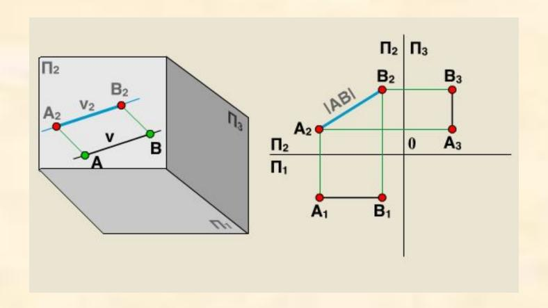
Прямая, параллельная фронтальной плоскости проекций, называется фронталью - f. На фронтальную плоскость проекций фронталь проецируется в натуральную величину. Графический признак фронтали – y=const.
