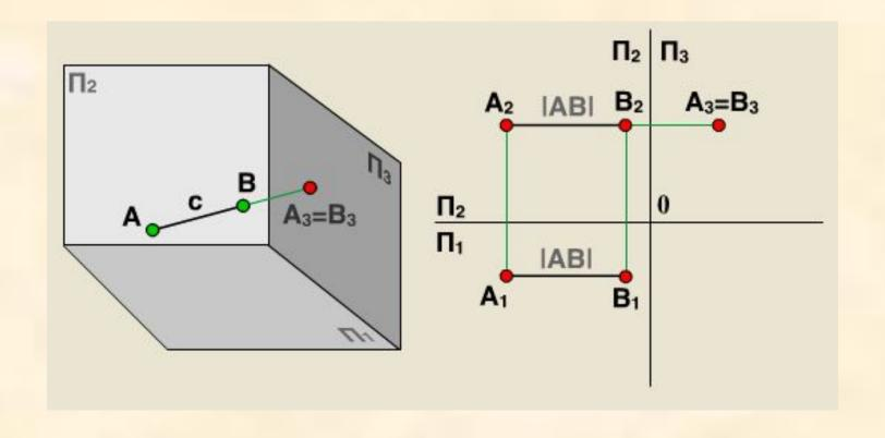
Профильно проецирующая прямая – прямая, перпендикулярная профильной плоскости проекций. Профильной проекцией такой прямой является точка, а горизонтальная и фронтальная проекции || оси х.
