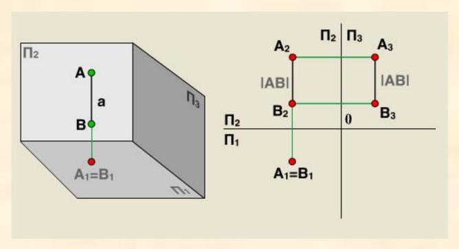
Горизонтально проецирующая прямая – прямая, перпендикулярная горизонтальной плоскости проекций. Горизонтальной проекцией такой прямой является точка, а фронтальная и профильная проекции || оси z.
