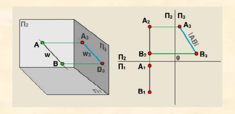
Прямая, параллельная профильной плоскости проекций, называется профильной прямой - р. На профильную плоскость проекций профильная прямая проецируется в натуральную величину.
