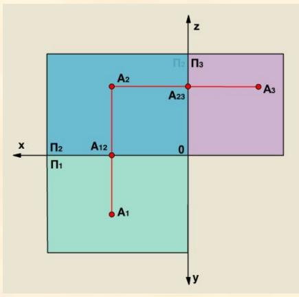
Полученный чертеж является трёхпроекционным ортогональным чертежом точки А.
