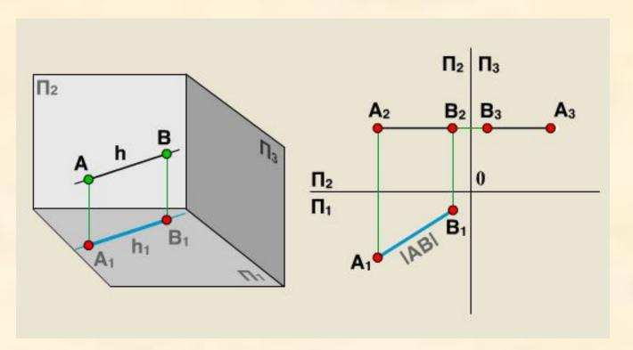
Прямая, параллельная горизонтальной плоскости проекций, называется горизонталью - h. На горизонтальную плоскость проекций горизонталь проецируется в натуральную величину. Графический признак горизонтали — z = const.
