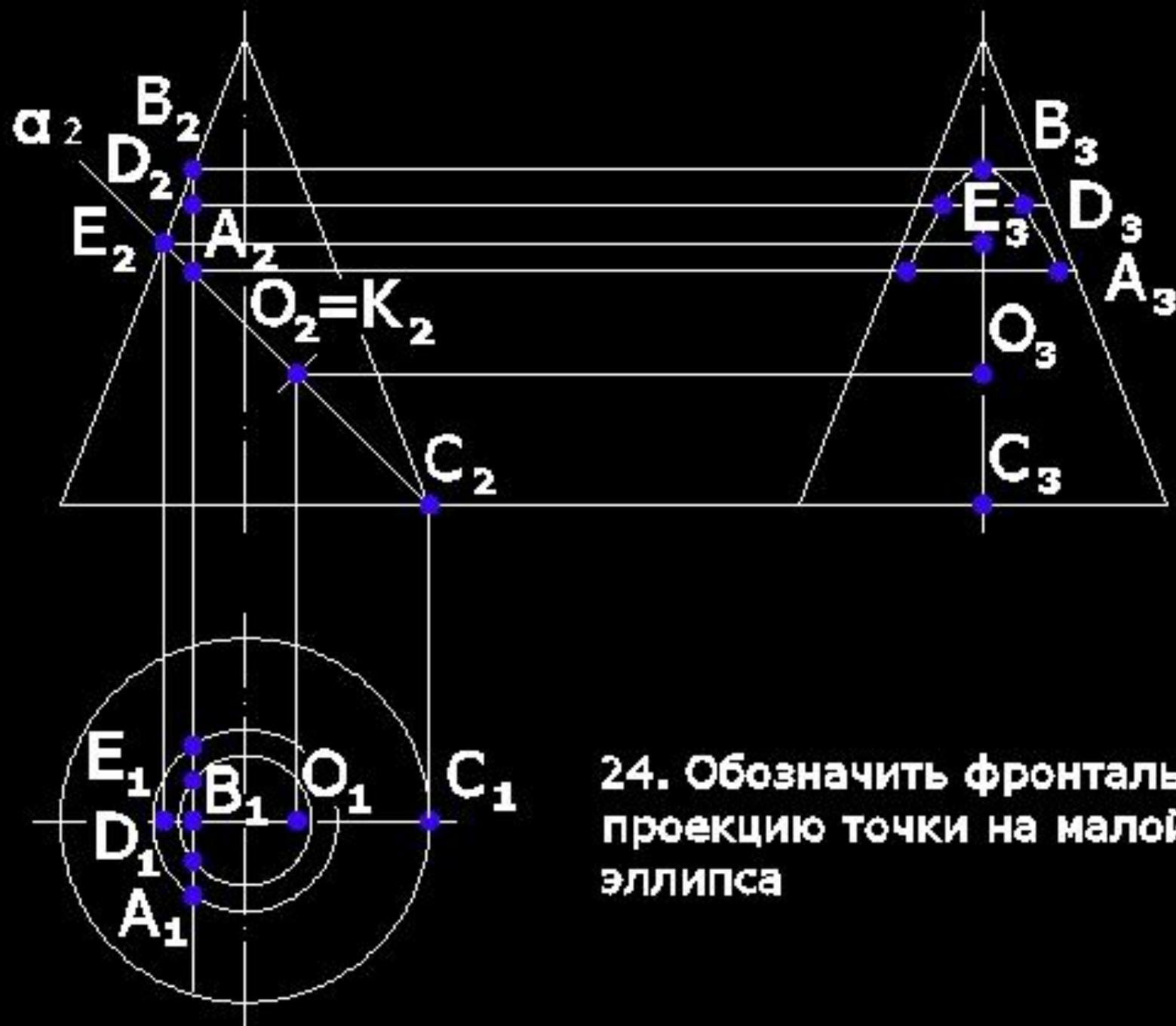
24. Обозначить фронтальную проекцию точки на малой оси эллипса
