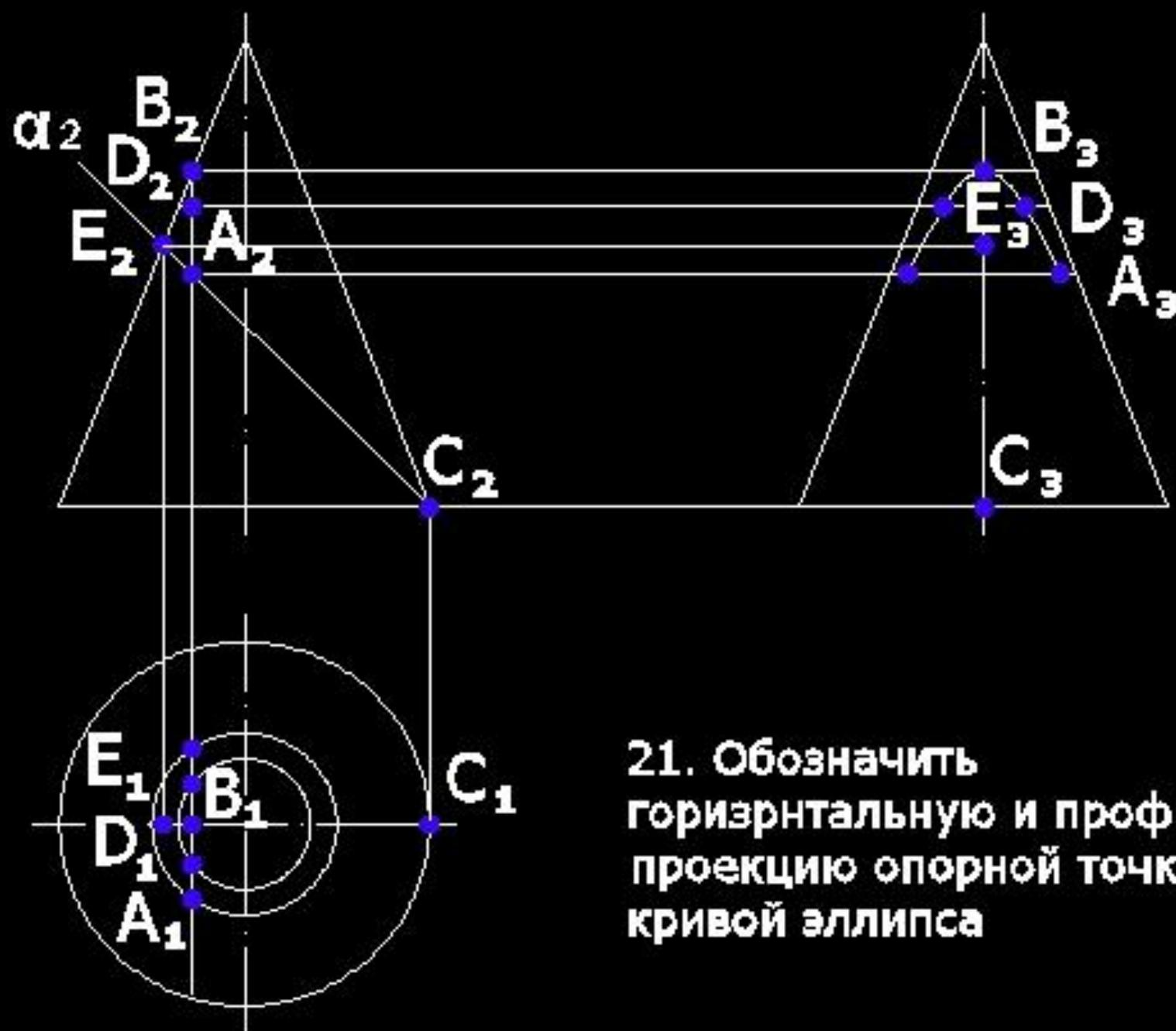
21. Обозначить горизонтальную и профильную проекцию опорной точки E кривой эллипса
