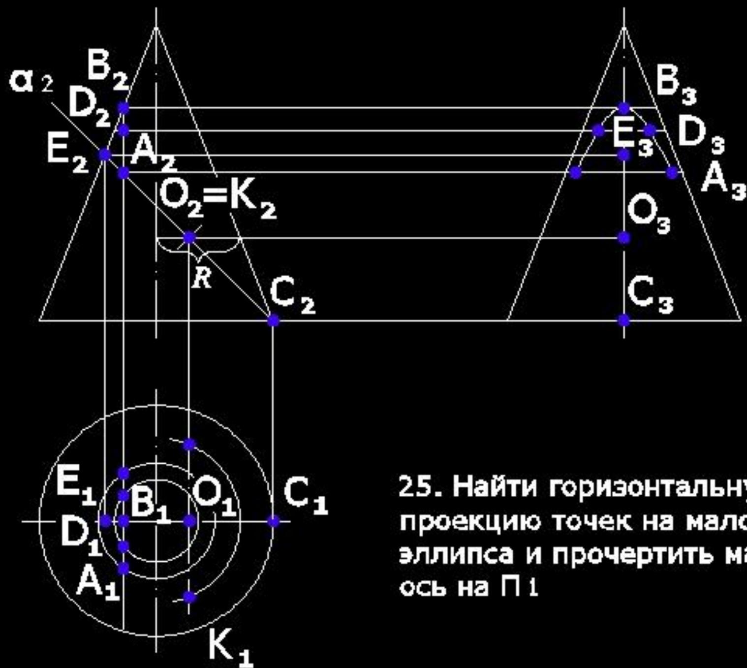
25. Найти горизонтальную проекцию точек на малой оси эллипса и прочертить малую ось на  $\Pi_1$
