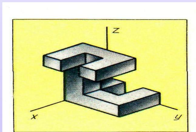
Изометрия – это одна из аксонометрических проекций.
