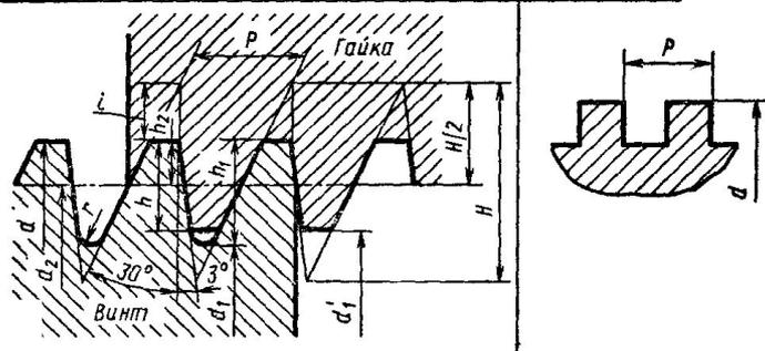
Круглую резьбу применяют при больших динамических нагрузках и при возможных загрязнениях пылью и грязью (пожарная арматура, крюки грузоподъемных машин).
