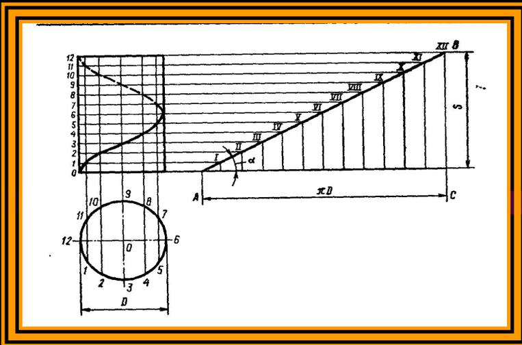
Под резьбой понимают поверхность, образованную при винтовом движении плоского контура по цилиндрической либо конической поверхности.
