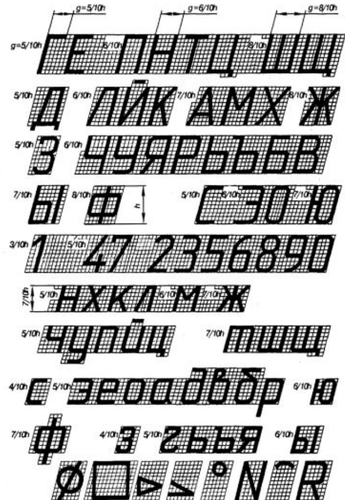
ШРИФТ ЧЕРТЕЖНЫЙ ТИПА Б ( d=1/10h ) С НАКЛОНОМ ОКОЛО 75^\circ (ГОСТ 2.304-81)
