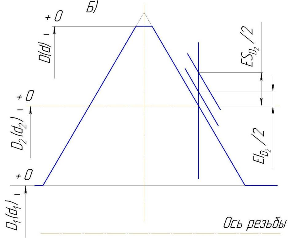
**ПОСТРОЕНИЕ ПОЛЯ ДОПУСКА НА НАРУЖНЫЙ ДИАМЕТР  $\varnothing D$**
