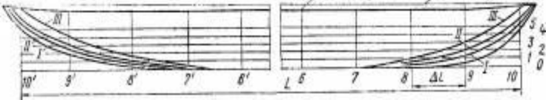
Ввиду симметрии судна относительно ДП на ОП проектируют только половину корпуса, и эту проекцию называют «Полуширота».
