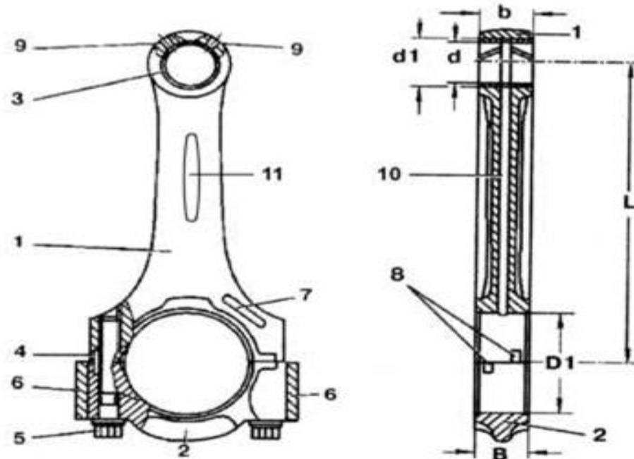
1— Шатун , 2 — Шатунная крышка, 3 — Втулка, 4 — Направляющие пазы, 5 — Шатунный болт, 6 — Балансировочные грузики , 7 — Идентификационное поле , 8 — Пазы для установки вкладышей , 9 — Масляный канал ,  $b$  — Ширина верхней головки шатуна,  $B$  — Ширина нижней головки шатуна,  $d$  — Внутренний диаметр втулки верхней головки шатуна ,  $d1$  — Наружный диаметр втулки верхней головки шатуна .
