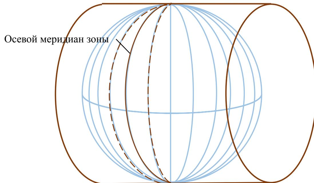
3. Каждую зону проецируют на поверхность цилиндра и разворачивают
