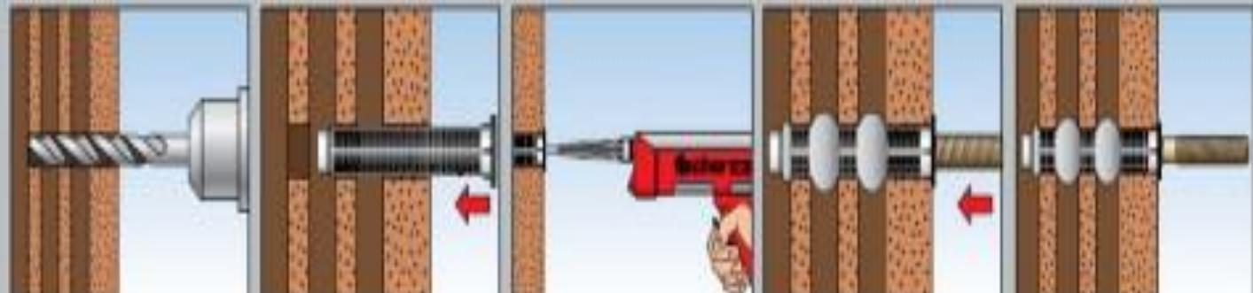
Просверлить отверстие. Установить анкерную гильзу. Заполнить гильзу раствором. Установить резьбовую шпильку или втулку. Дать раствору затвердеть. Готово!
