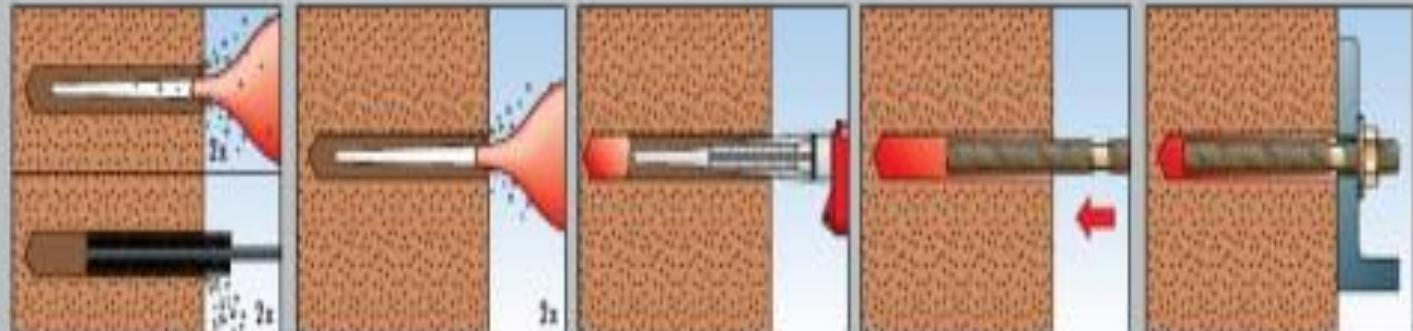
Дважды продуть и прочистить щеткой просверленное отверстие. Еще раз дважды продуть отверстие. Заполнить отверстие раствором. Установить резьбовую шпильку или втулку. Дать раствору затвердеть. Готово!
