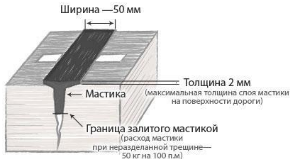
рис. 3. Неразделанная трещина
