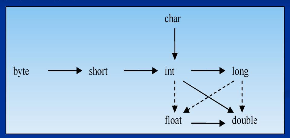
Штриховой линией отмечены разрешенные автоматические преобразования, которые при определенных значениях переменной могут выполняться *с потерей* информации.
