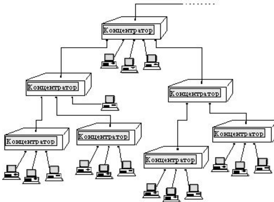
Мост (bridge), а также его быстродействующий функциональный аналог – коммутатор (switching hub), делит общую среду передачи данных на логические сегменты. Логический сегмент образуется путем объединения нескольких физических сегментов (отрезков кабеля) с помощью одного или нескольких
