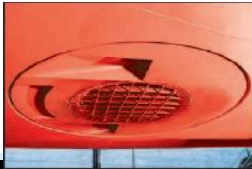
Рис. б Водомет с центробежным насосом фирмы Schottel
