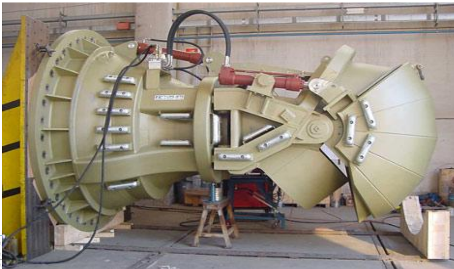
Рис.а Водомет с осевым насосом фирмы HYFLO
