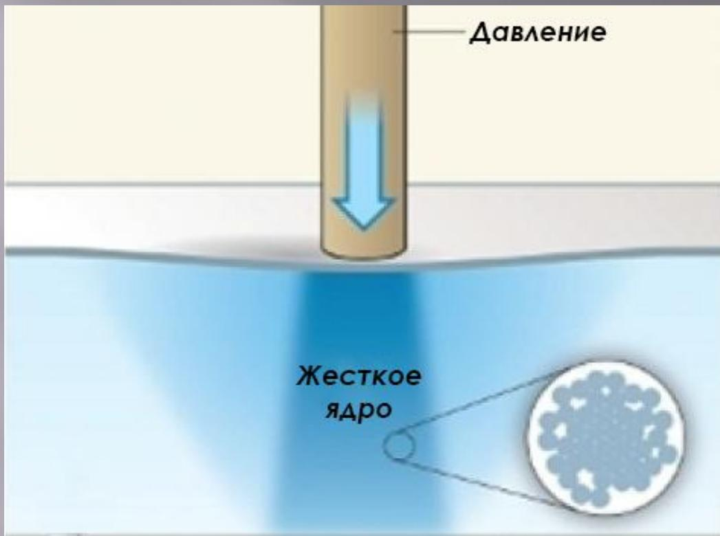
Если к вязкопластичной жидкости прикладывать напряжение сдвига, меньшим по величине, чем пороговое значение, то такая жидкость будет оставаться в покое. Как только напряжение сдвига превысит, вязкопластик начнет течь, как обычная ньютоновская жидкость. Иначе говоря, привести в движение вязкопластичную жидкость можно, лишь преодолев её предельное напряжение.
