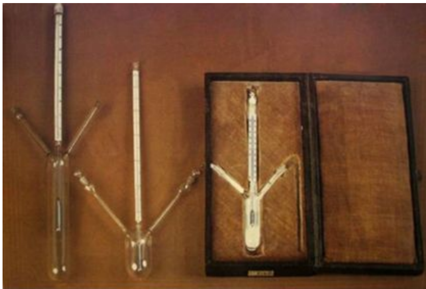
Пикнометр конструкции Д.И. Менделеева
