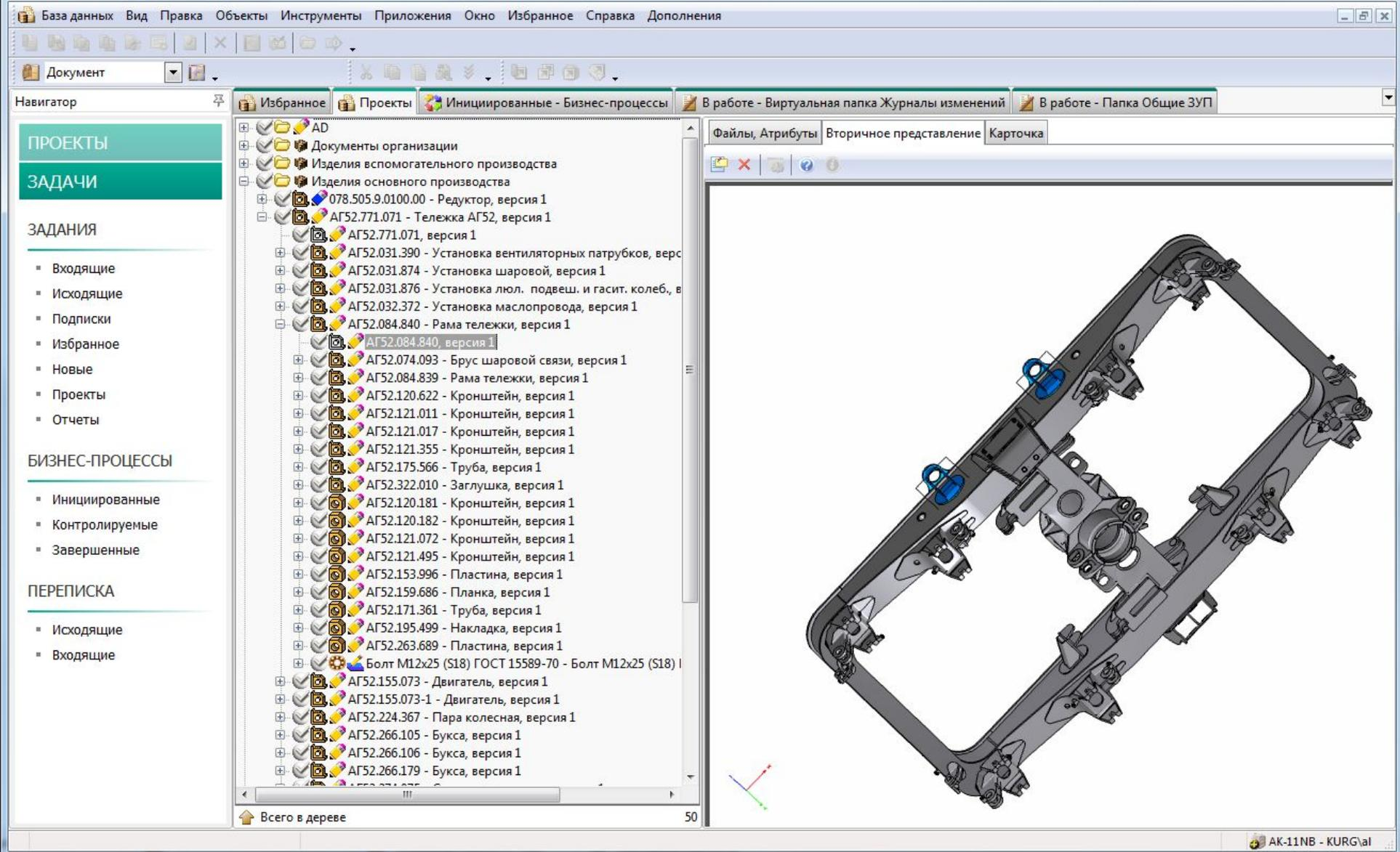
Рисунок 4 – Комплект конструкторско-технологической документации в системе ЛОЦМАН:PLM
