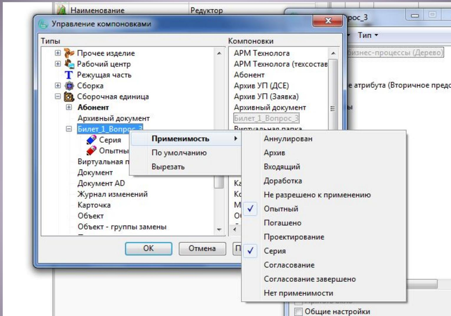
Рисунок 8 – Состояния объекта конструкторско-технологической документации в ЛОЦМАН:PLM
