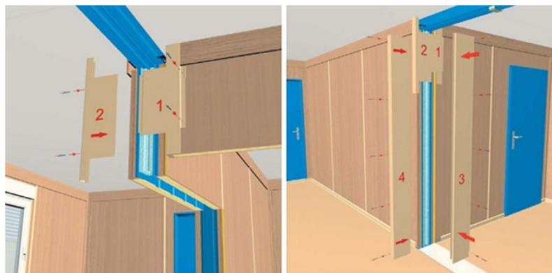
На стыке двух блок - модулей обеспечивается надежное и герметичное соединение, которое образуется с помощью элементов, входящих в комплект внешнего соединения. Выше, представлены варианты формирования внешнего соединения двух или нескольких блок-модулей.
