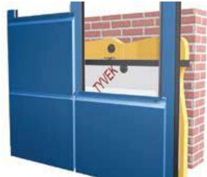
Внешняя отделка модулей выполнена по технологии вентилируемого фасада с применением Фасадных кассет . Фасадные кассеты производятся из оцинкованной стали, толщиной 0,7-1,2 мм с различными видами полимерного покрытия (полиэстер, Colorcoat Prisma™, PVDF и др.), обеспечивающим защиту материала от механического воздействия, атмосферных явлений и придающим эстетичный внешний вид. К особенностям фасадных кассет относится их небольшой вес при обеспечении высоких показателей прочности.
