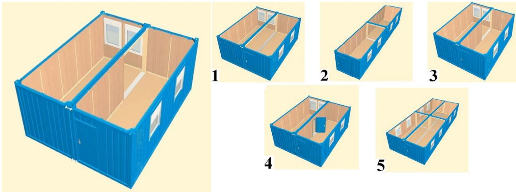
Как видим, модули можно соединять между собой различными сторонами. Поверхность, на которую устанавливается модуль (асфальт, деревянный брус, бетонная плита и т. д.) должна обеспечивать для каждого модуля не менее 6-ти точек опоры. Если в конструкцию модульного здания решено включить капитальный фундамент, то его глубина будет зависеть от индивидуальных условий проекта.
