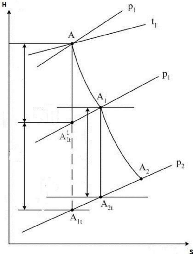
$A$  - состояние пара при параметрах торможения
