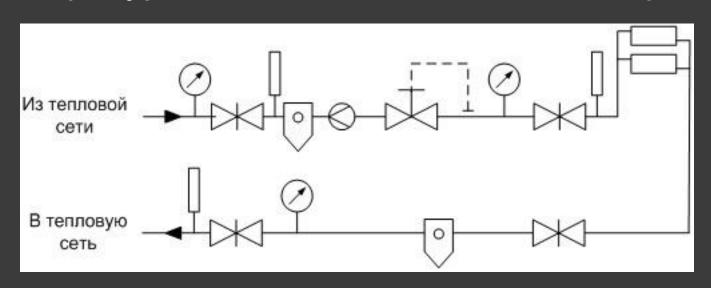
• Здания присоединяются непосредственно, без смешения. Достаточно иметь задвижки на подающем и обратном трубопроводах системы отопления и необходимые КИП. Давление в тепловой сети в точке присоединения должно быть меньше допустимого. Наименьшей прочностью обладают чугунные радиаторы, для которых давление не должно превышать 60 м.вод. ст. Иногда устанавливают регуляторы расхода.
