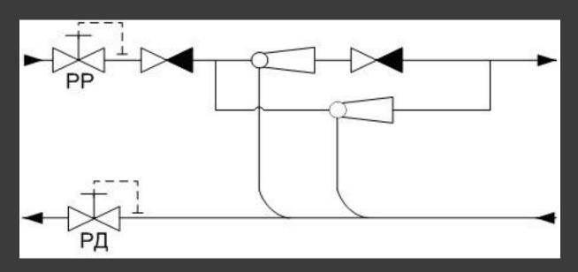
Отключение одного элеватора ведет к снижению расхода сетевой воды и повышению коэффициента смешения. Каждый элеватор может быть рассчитан на 50% расхода воды, либо один на 30-40%, а другой на 70-60%.
