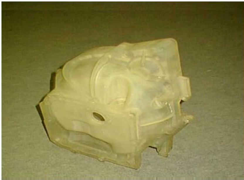
Прототип картера коробки передач двигателя «Рено»
