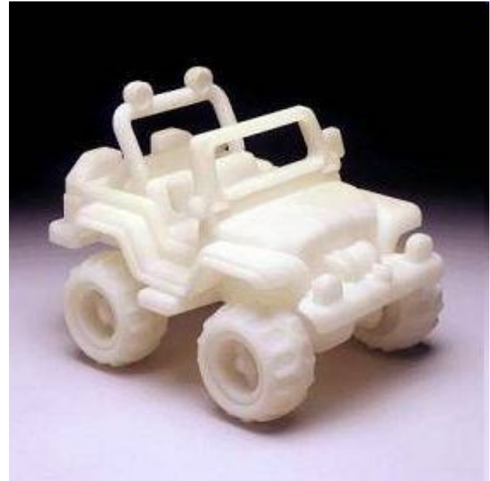
Модель, выращенная на 3D-принтере по технологии Solid Ground Curing
