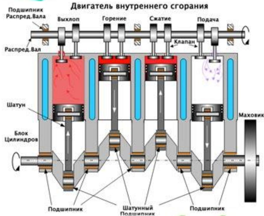
Двигатель – это сердце автомобиля. Будь то бензиновый, газовый двигатель (работающий за счет сгорания в нем воздушно-топливной смеси, приводящей двигатель в движение) или же электродвигатель (работающий за счет вращения вала под действием магнитного поля, создаваемого движением электрического тока по медным проводам), основной сутью является приведение в движение **маховика** (большой шестерни), вращение с которого передается на колеса автомобиля
