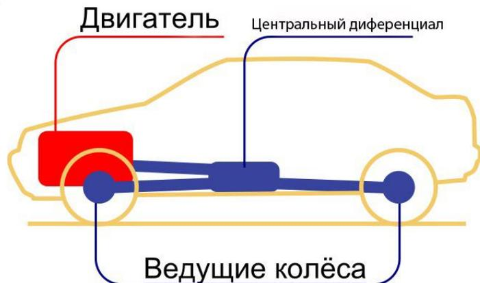
Разобравшись с тем, как вращение доходит от двигателя до колес автомобиля, разберемся с еще одним важным нюансом – приводами автомобилей.
