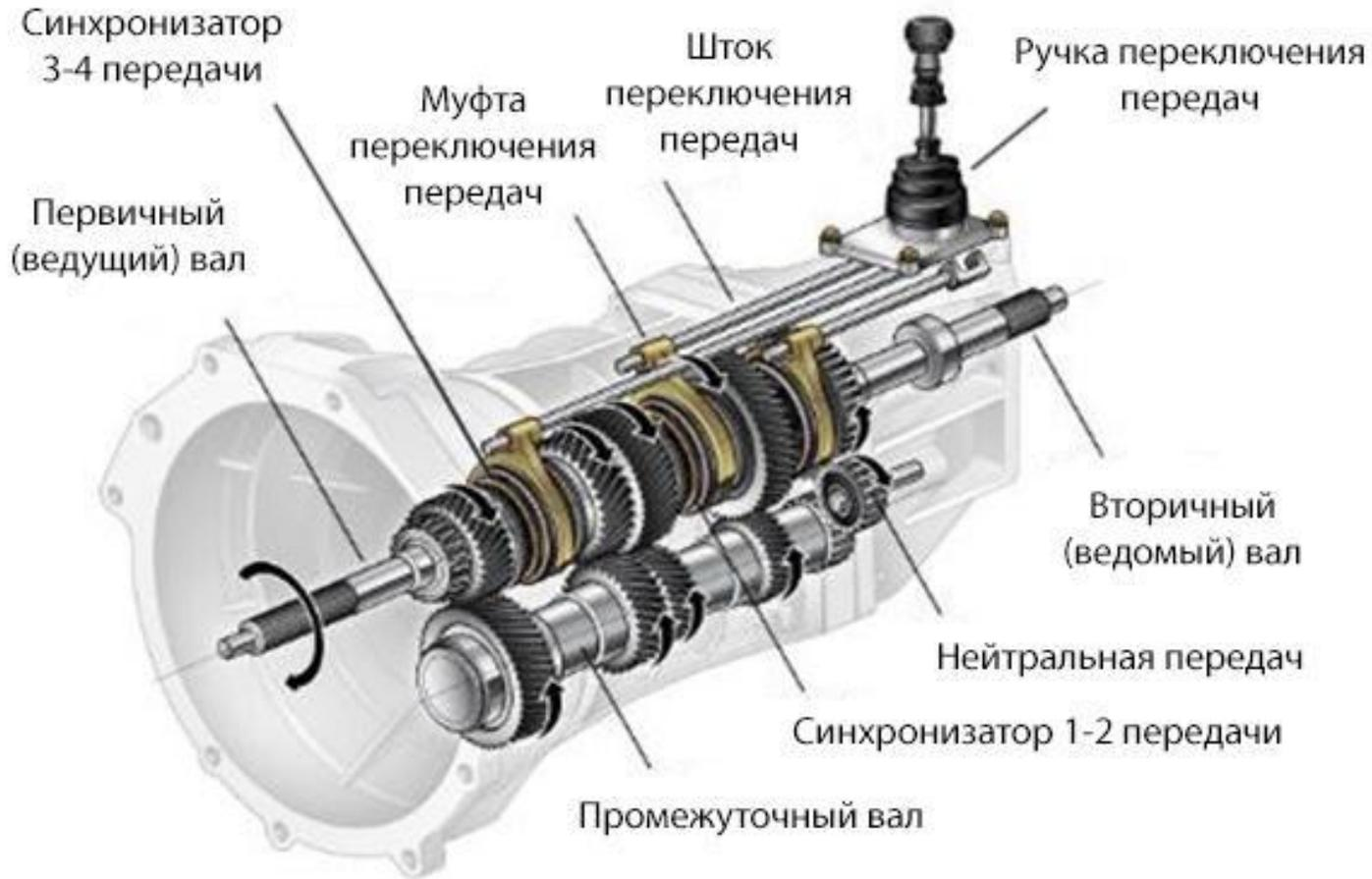
Для того чтобы управлять движением автомобиля в зависимости от разных условий (ровная или ухабистая дорога, асфальтированная или грунтовая, сухая или влажная, заснеженная или чистая), вращение маховика передается к колесам через **трансмиссию** автомобиля. Одним из важнейших узлов трансмиссии является **коробка передач**.
