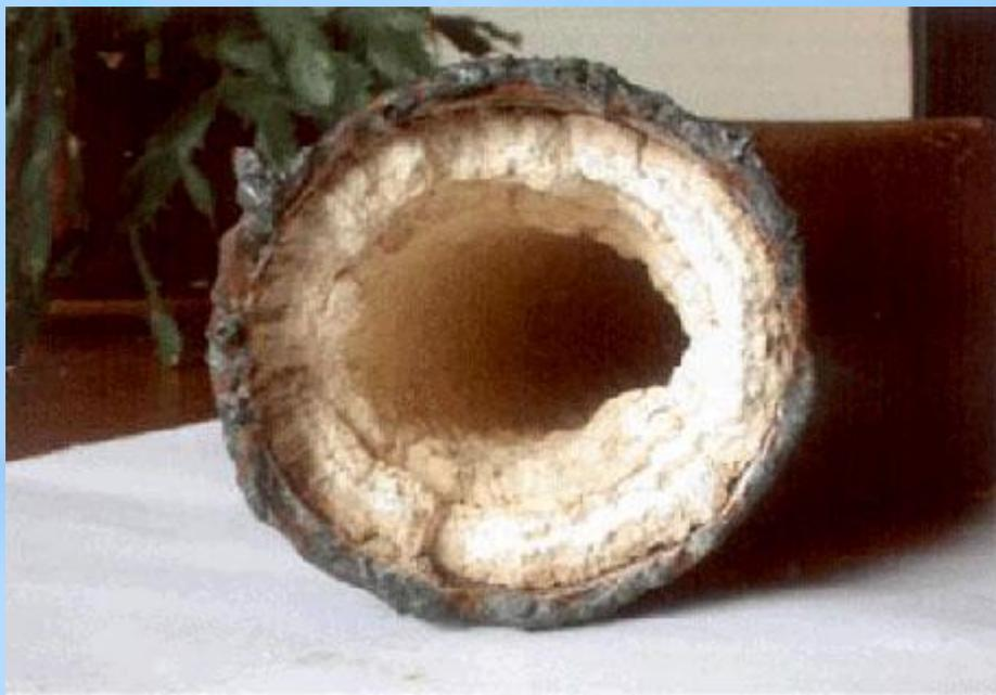
Для понижения жесткости воды применяют различные методы. Перед направлением в паровой котел воду предварительно нагревают, чем устраняют временную жесткость. Для питания котлов высокого давления в настоящее время часто применяют дистиллированную воду. Для понижения жесткости воды используют химические методы, приводящие к переводу ионов кальция и магния в состав нерастворимых солей, обычно в карбонаты.
