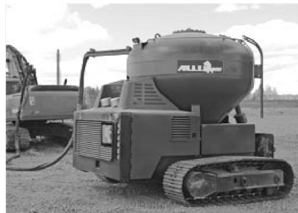
Самоходный бункер (а) с пневматическим насосом и смеситель (б) (Финляндия)
