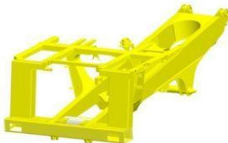
**Рама** — сварная из высокопрочной низколегированной стали. Лонжероны коробчатого сечения переменной высоты, соединены между собой поперечинами. В местах наибольшего нагружения применяются литые элементы.
