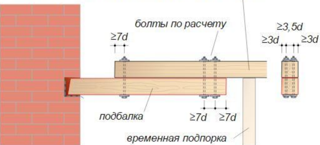
усиливаемая балка с отпиленным подгнившим концом
