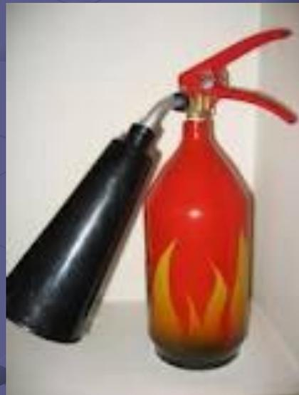
Попадая в зону горения, углекислота действует как мощный охлаждающий фактор. Одновременно она резко снижает содержание кислорода в очаге пожара. Благодаря этому огнегасящий эффект очень велик. Вес огнетушителя в заряженном состоянии – 6,3 кг, время его действия – 30 сек.
