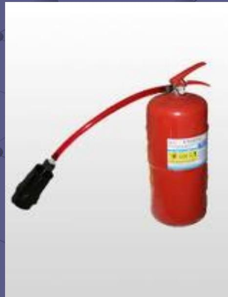
Емкость этого огнетушителя всего 5 л, однако за счет значительного увеличения кратности образования пены из раствора ее получается не менее 250 л, т. е. в пять раз больше, чем в огнетушителях ОП-3 и ОХП-10, при емкости корпуса почти в 2 раза меньшей. Соответственно уменьшается и масса огнетушителя — с 13,2 до 7,5 кг.
