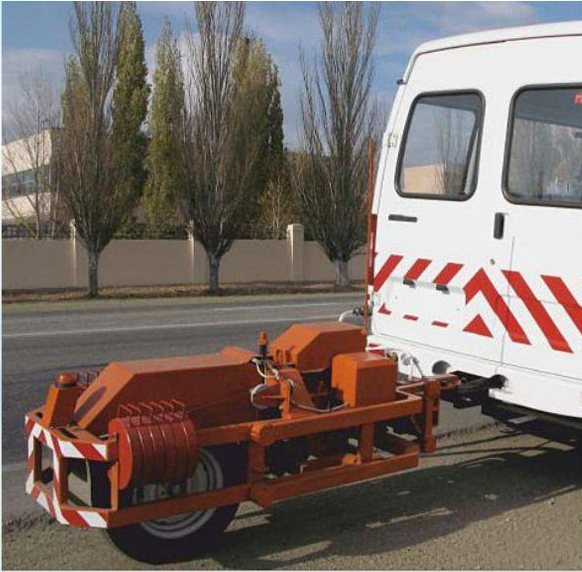
Профилометр представляет собой автомобиль, на котором размещены необходимые датчики и компьютер, обеспечивающие измерение и регистрацию высотных отметок поверхности движения в полосе длин волн неровностей 0,5 - 60 м для автомобильных дорог и 0,5 - 100 м для аэродромов.
