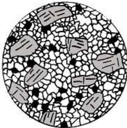
Полнокристаллическая неравномернозернистая (порфировидная) структура .
