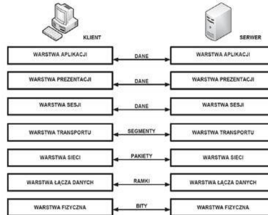
Rysunek 11. Jednostki informacji w poszczególnych warstwach w modelu odniesienia ISO/OSI
