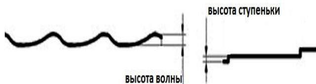
**Высота ступеньки** – элемент придающий рельеф в поперечном направлении.
