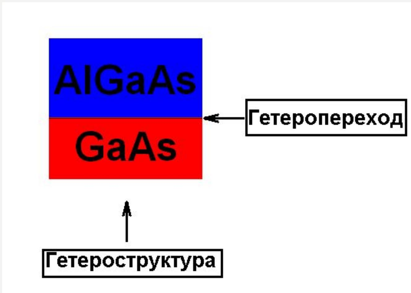
Термин в физике полупроводников, обозначающий выращенную на подложке слоистую структуру из различных полупроводников, в общем случае отличающихся шириной запрещённой зоны
