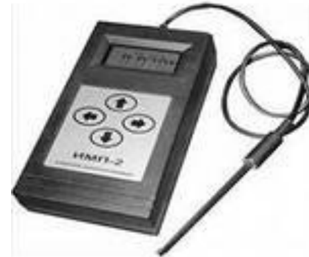
Измеритель магнитной индукции портативный ИМП-2
