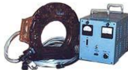
Дефектоскоп магнитопорошковый МД-12ПЭ
