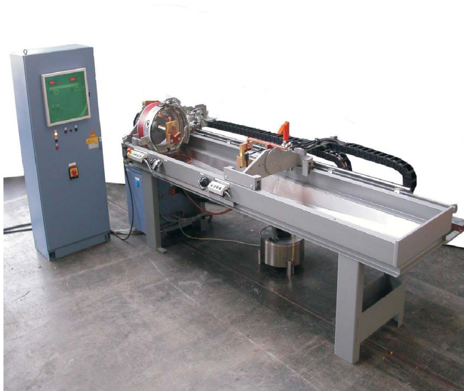
дефектоскоп «Universal-SW» фирмы "Tiede"
