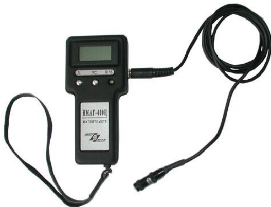
Измеритель напряженности магнитного поля ИМАГ-400Ц
