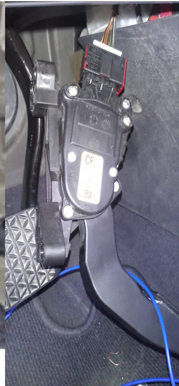
1 – датчик положения педали сцепления; 2 – выключатель сигнала торможения; 3 – модуль педали газа
