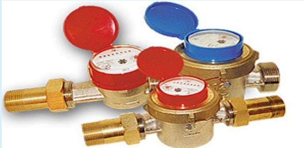
На вводах внутреннего водопровода устанавливаются скоростные крыльчатые (УВК) и турбинные (ВТ и ВТГ) водомерные счетчики. В крыльчатых счетчиках, имеющих диаметры прохода около 15-40 мм и устанавливаемых исключительно на горизонтальных участках трубопровода, движение воды происходит перпендикулярно оси вращения вертушки, расположенной в корпусе счетчика. При этом вертушка вращается со скоростью, прямо пропорциональной скорости движения воды.
