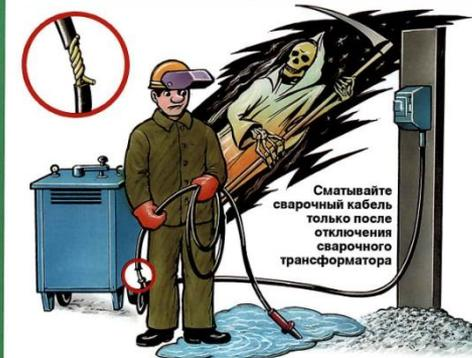
Сматывайте сварочный кабель только после отключения сварочного трансформатора
