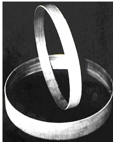
Рис. 6. - Примеры композитов с борным волокном:
