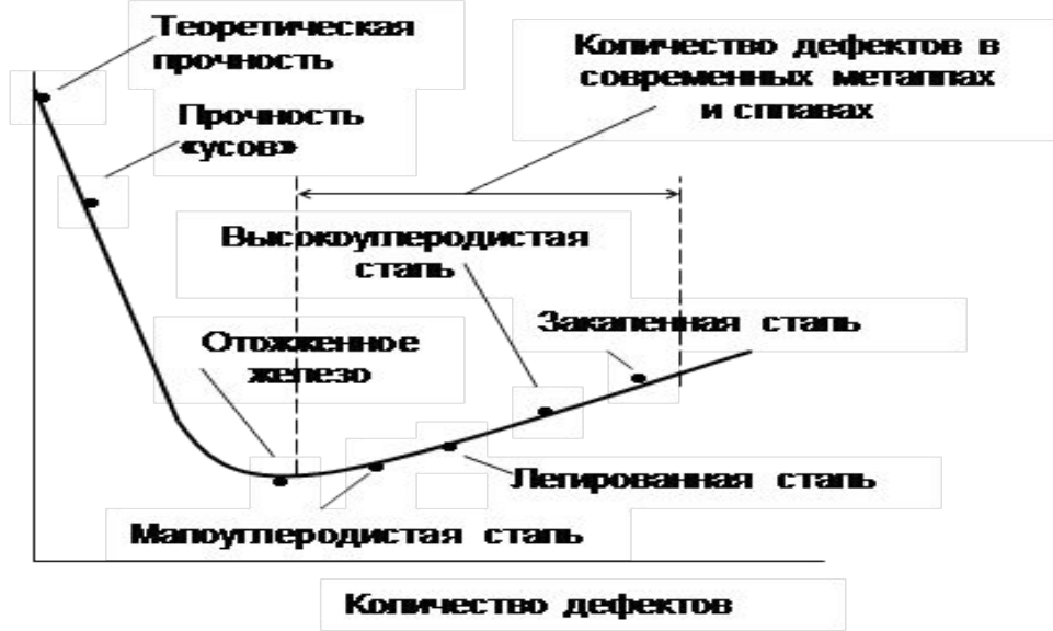
Рис. 1.4. Влияние количества дефектов на прочность сплава (стали).
