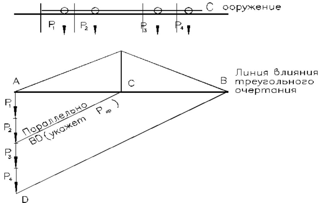
Силы  $P_1$ ,  $P_2$ ,  $P_3$ ,  $P_4$ ... откладываются из точки А в масштабе вниз, в той последовательности, в которой они действуют на сооружение слева направо. Затем проводят прямую, соединяющую правую опорную точку В линии влияния с концом обложенных грузов Д, после чего из точки С (основания  $Y_{\max}$ ) проводят прямую, параллельную линии ВД, которая своим нижним концом укажет тот груз, который и является критическим.
