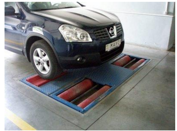
Диагностика состояния подвески на вибростенде
