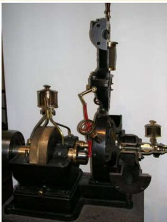
Турбина Лавалья. P_{\text{вх}} = 5 \text{ бар} , P_{\text{вых}} = 5 \text{ бар} , T_{\text{вх}} = 150^\circ\text{C} , n = 30 \text{ тыс. об/мин.} , N = 7,3 \text{ кВт}
