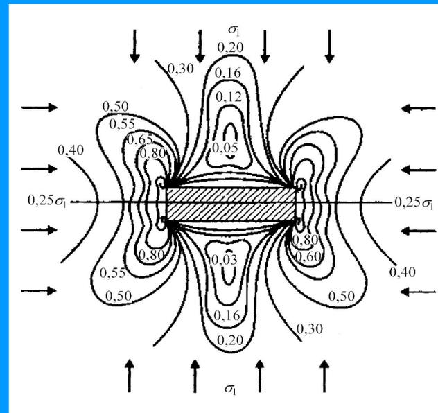
Изолинии напряжений вокруг прямоугольной выработки:
