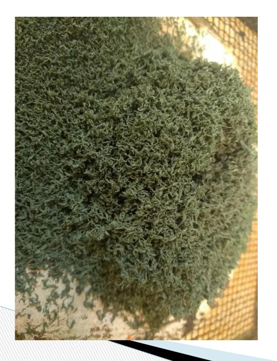
Дихромат аммония высыпала на металлическую пластину в форме горки. Затем при соприкосновении с огнем начался процесс разложения. Получилось подобие вулкана, и3 которого выбрасывались яркие искры и зеленый «пепел» - оксид хрома (зеленый пигмент). ВЫВОД: Художник может получить пигмент краски ДΛЯ ходе химической реакции, тем более, что ингредиенты для этой реакции легко доступны.
