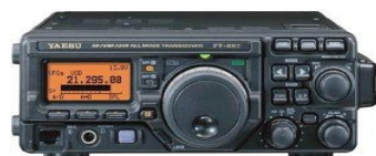
Стационарная УКВ радиостанция
