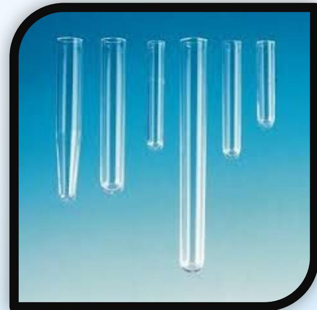
Пробирка — специализированный сосуд цилиндрической формы, имеющий полукруглое, коническое или плоское дно. Используется для проведения некоторых химических реакций в малых объемах, для отбора проб химических веществ.
